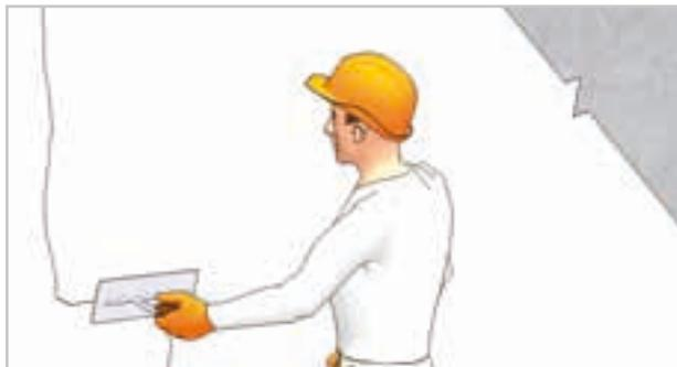
Después del endurecimiento inicial y el secado de MULTICEM e INCOLLARASA (2-3 días según el clima), proceda con el acabado con MULTIRASO INTERNI.
