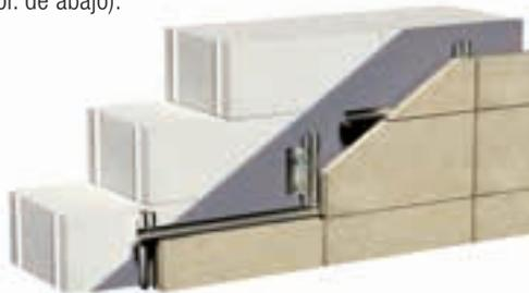
En este caso, antes de anclar la subestructura a la fachada, aplique MULTICEM o INCOLLARASA no armado. Con unos tacos adecuados (p. ej., Fischer SXRL o FIS V), el sistema de anclaje elegido a la estructura del edificio o al muro (subestructuras metálicas, sistema puntual, sistema mixto) y, posteriormente, colocar los azulejos de revestimiento.
